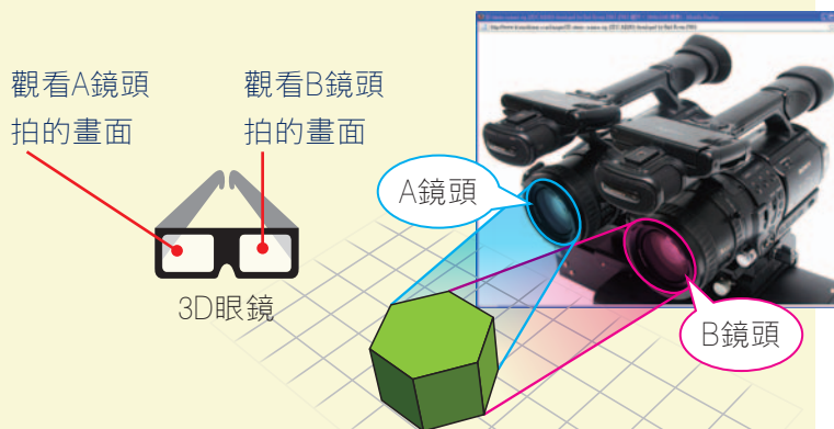
圖5-29 3D眼鏡原理示意圖
