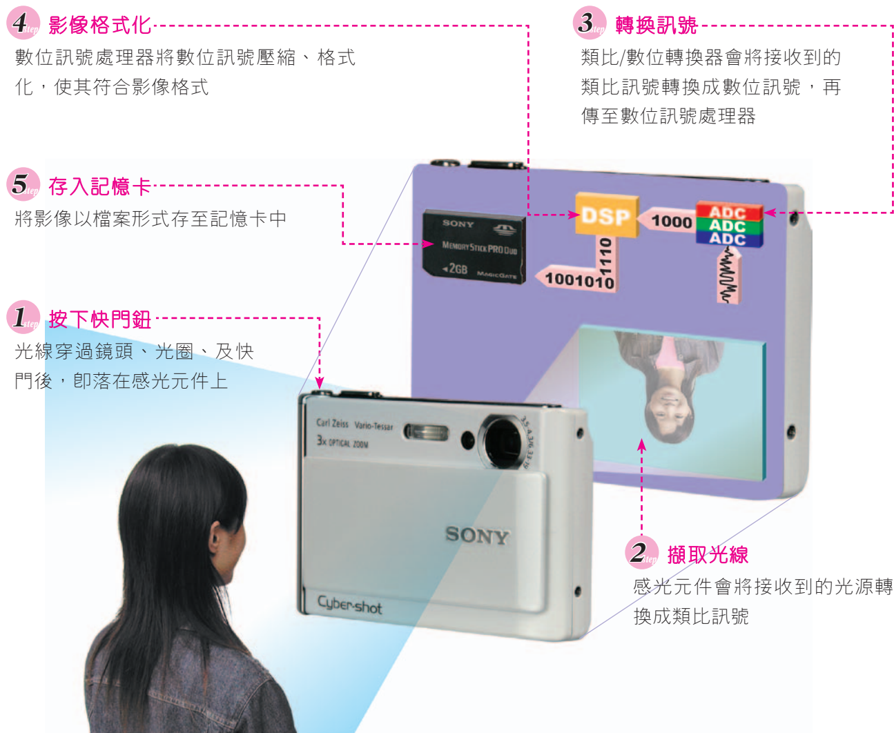
圖5-22 數位相機的工作原理
