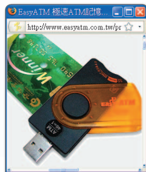
圖5-44 可存取記憶卡、IC晶片卡等卡片內容（此圖為IC晶片卡讀卡機）
