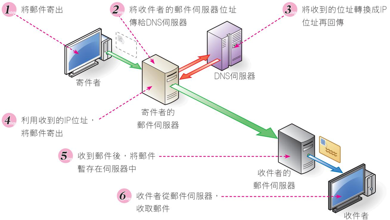
圖11-22 電子郵件的運作示意圖
