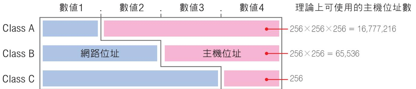
圖11-7 Class A、B、C的比較示意圖
