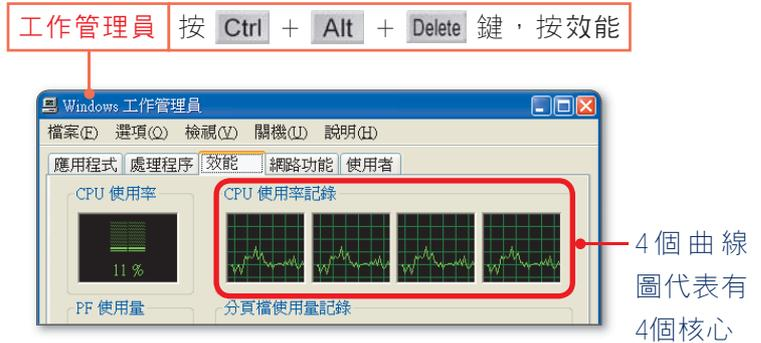
圖4-5 檢視CPU各個核心的使用率
