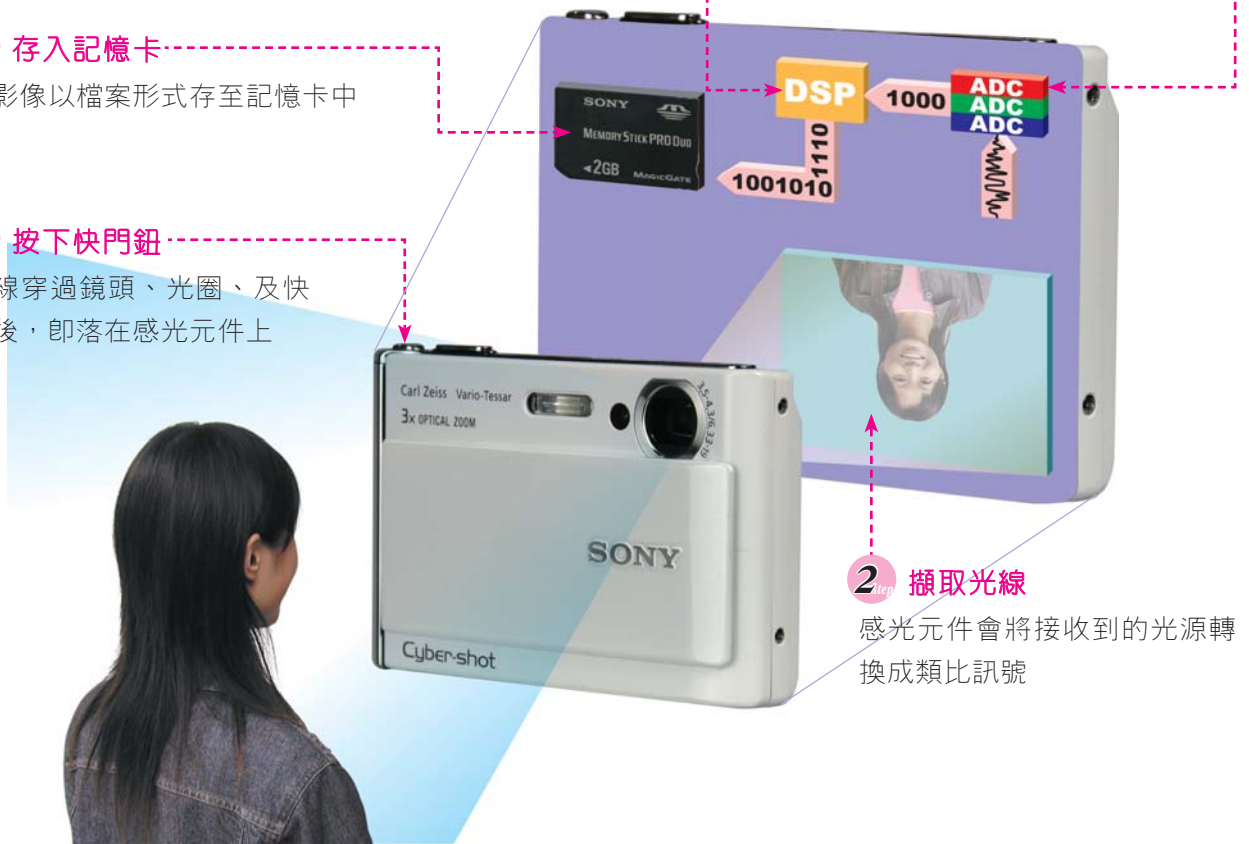
圖5-23 數位相機的工作原理
